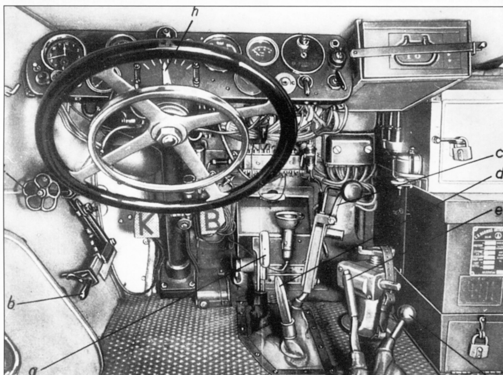
Отделение управления бронеавтомобиля Sd.Kfz.231(6-Rad). Обращает на себя внимание обратный наклон рулевого колеса
