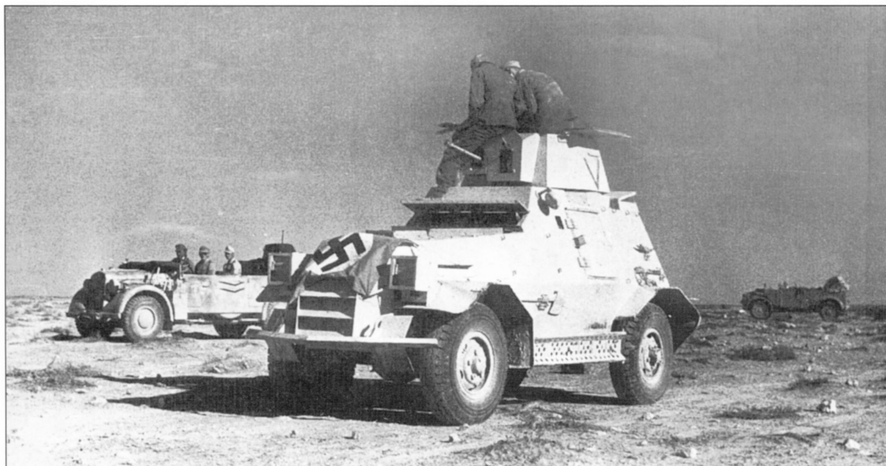
Трофей Вермахта — южноафриканский бронеавтомобиль Marmon-Herrington Mk III. На капоте машины растянута так называемый Fliegersichttuch — «полотнище для опознавания авиацией»
