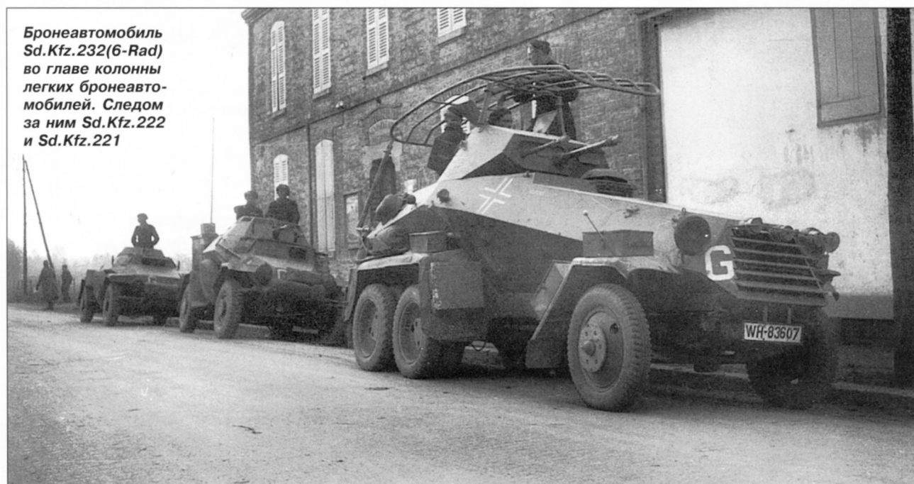
Бронеавтомобиль Sd.Kfz.232(6-Rad), а точнее — еще Kfz.67a, так как на машине регистрационный номер Рейхсвера. Судя по жалюзи радиатора, это машина фирмы Krupp
