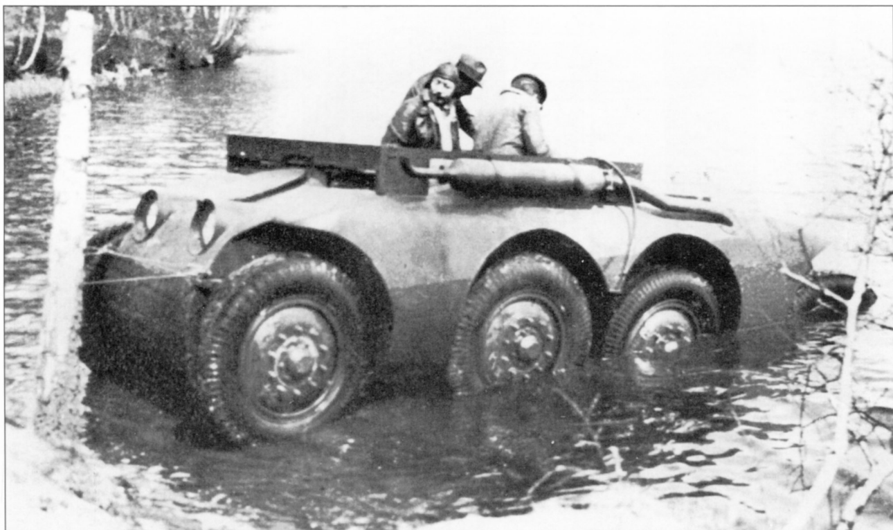
Шасси Daimler-Benz ARW во время испытаний. 1929—1930 годы
