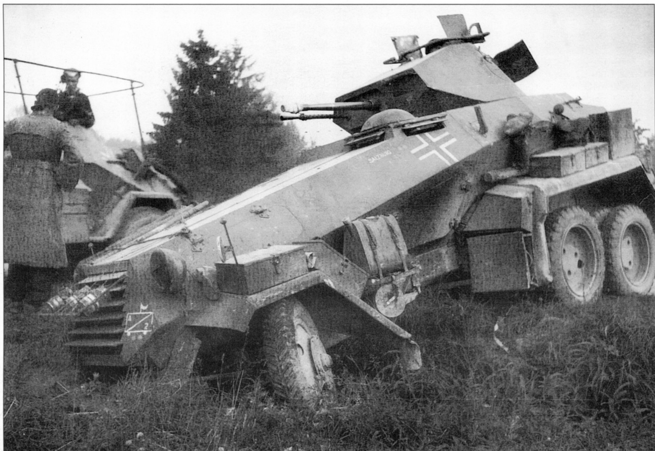
Бронеавтомобиль Sd.Kfz.231(6-Rad). Франция, 1940 год. На жалюзи радиатора укреплены дымовые шашки
