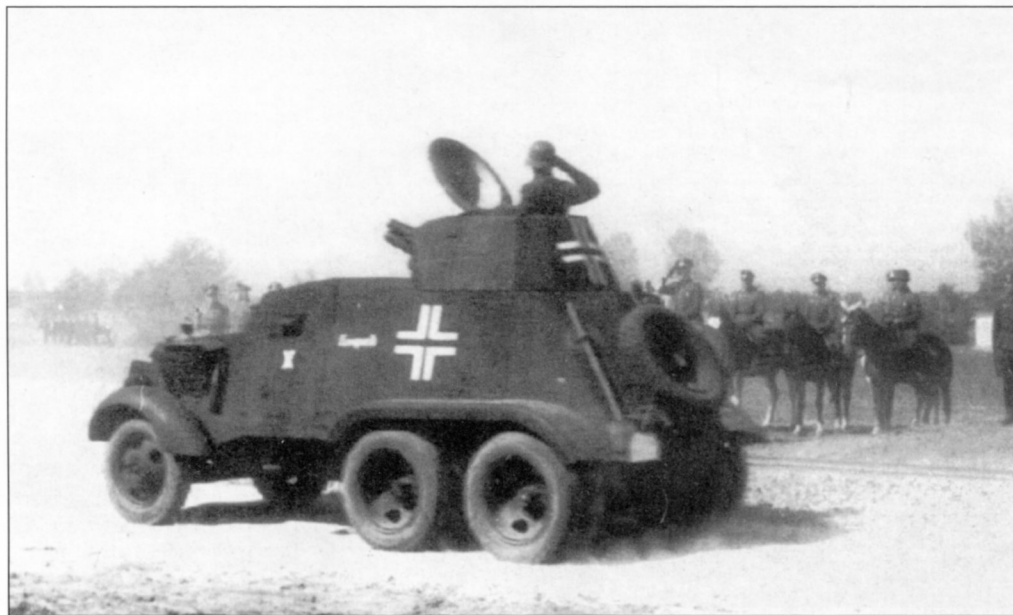
Бронеавтомобиль AAC-1937 Gerard на параде в одной из частей Вермахта на Восточном фронте. На машине установлена башня с 37-мм пушкой Puteaux
