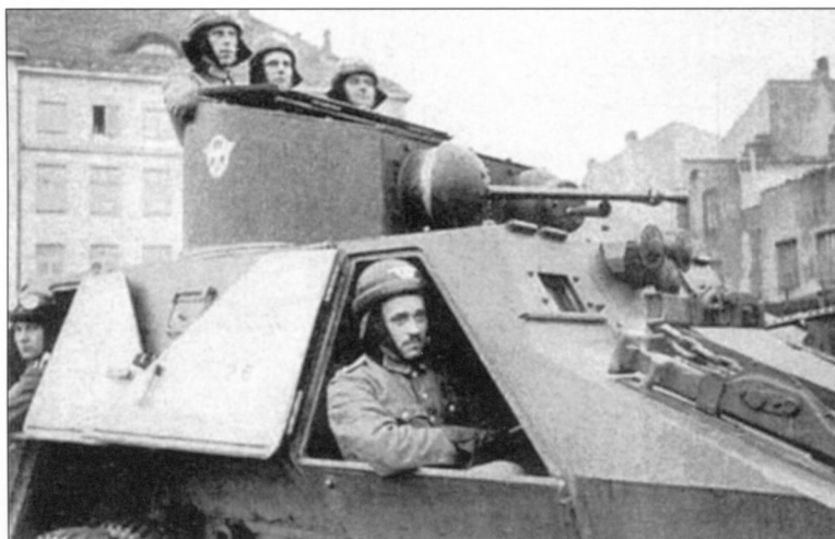
ADGZ крупным планом. Хорошо видна посадка водителей
