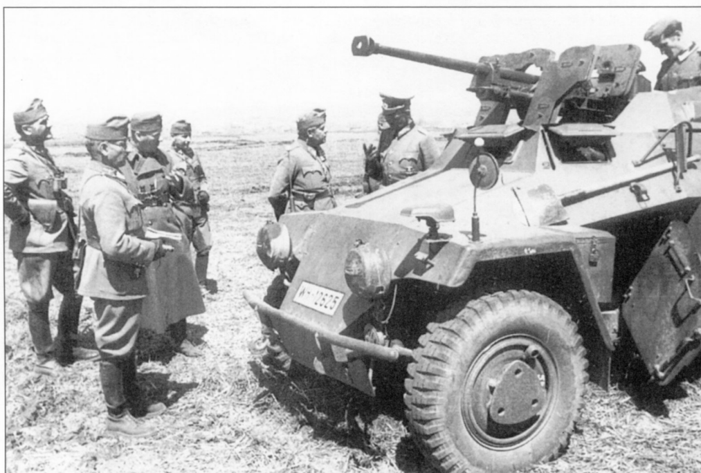
Румынские офицеры осматривают немец- кий бронеавтомо- биль Sd.Kfz.221, во- оруженный тяжелым 28-мм противотанко- вым ружьем sPzB 41. Восточный фронт, лето 1942 года
