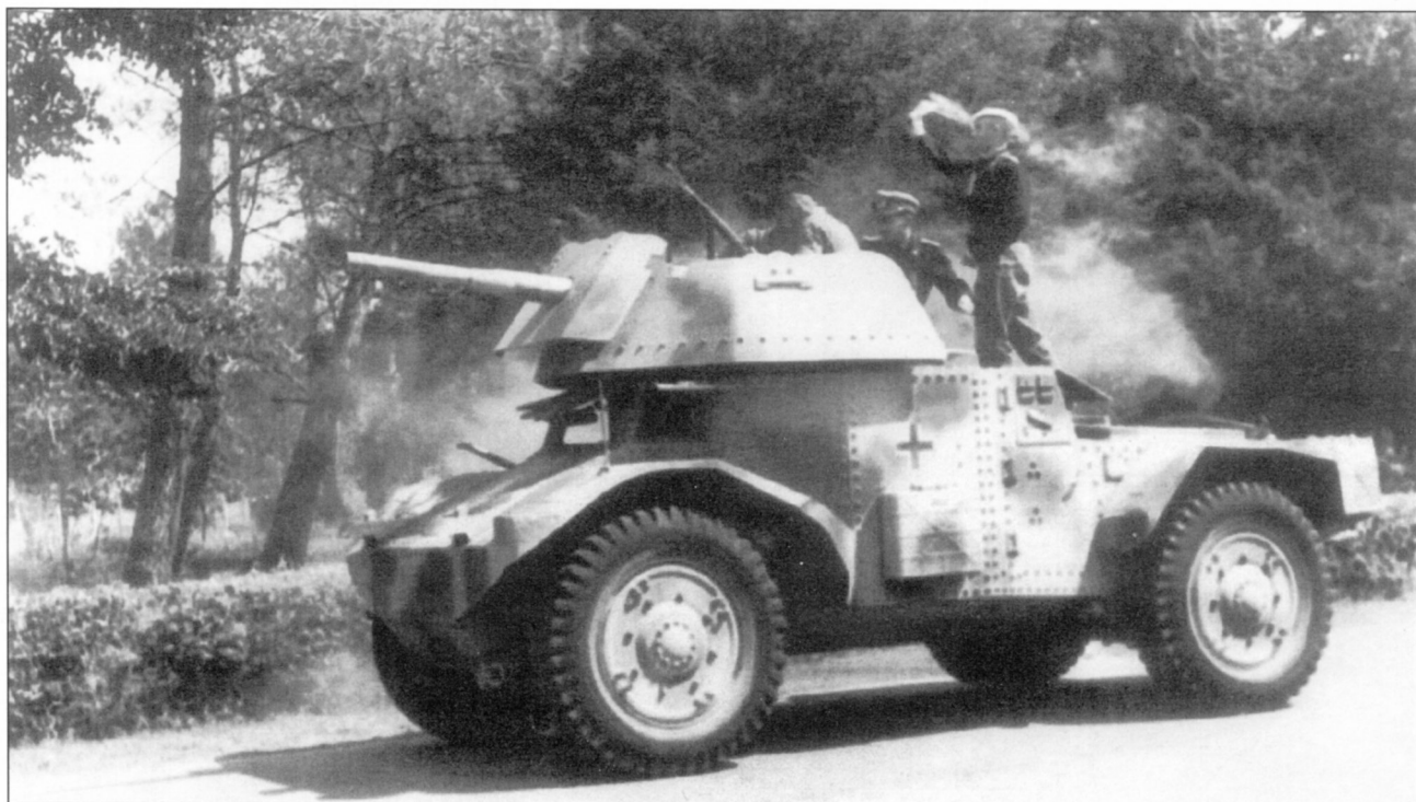
Броневомобиль Pz.Spah.204(f), осна- щенный новой, от- крытой сверху, баш- ней с 50-мм пушкой KwK L42. 1943 год
