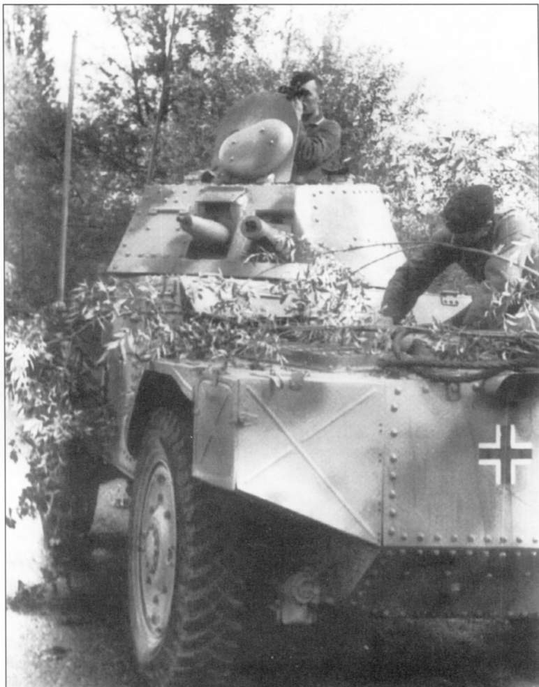
Бронев автомобиль Pz. Spah. 204(f). Франция, 1943 год. Вместо 25-мм пушки на этой машине установлен второй пулемет
