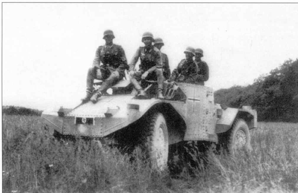
Бронеавтомобиль Panhard AMD178 в 39-м противотанковом дивизионе 3-й немецкой танковой дивизии. Лето 1940 года. У машины отсутствует башня, а в качестве вооружения используются два пулемета MG 34
